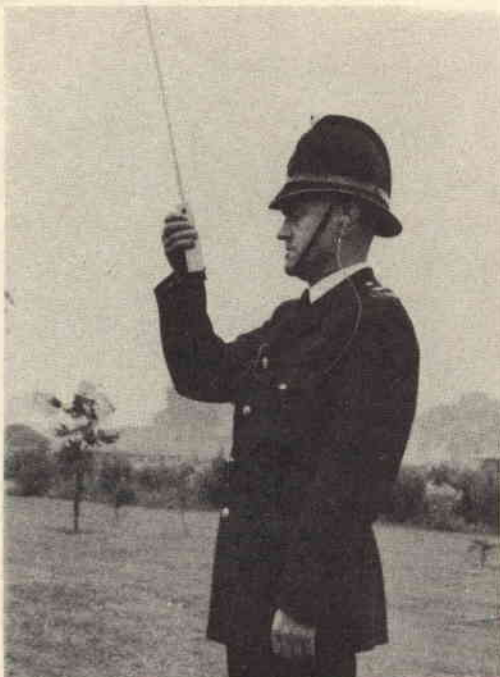
Un agente inglese fa un rapporto al comando per mezzo di un'apparecchiatura radio tascabile; si noti l'antenna telescopica del trasmettitore ed il filo che dal ricevitore va all'auricolare.
